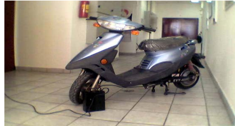
ΕΙΚΟΝΑ 4-6: Ηλεκτρικό σκούτερ σε διαδικασία φόρτισης
