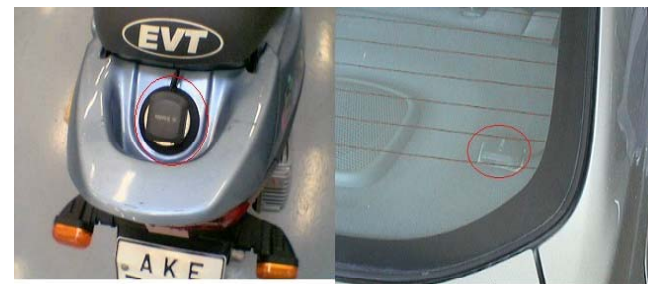
ΕΙΚΟΝΑ 6-5:Κεραίες GPS στο ηλεκτρικό μηχανάκι (αριστερά) και το Toyota Prius (δεξιά)
